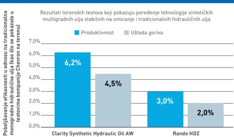
Korišćenjem premijum hidrauličnih tečnosti, produktivnost i efikasnost potrošnje goriva mogu da se unaprede u odnosu na korišćenje tradicionalnih ulja, kao što je ovde prikazano.
