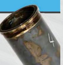
Nema rupičaste korozije na plaštu niti štetnih naslaga nakon što je pređeno 2,5 miliona kilometara uz korišćenje ulja Delo XLC.
